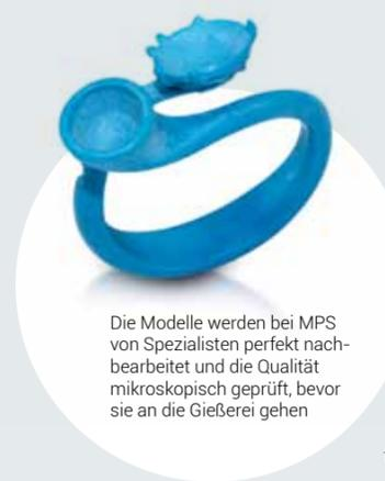
Die Modelle werden bei MPS von Spezialisten perfekt nachbearbeitet und die Qualität mikroskopisch geprüft, bevor sie an die Gießerei gehen
