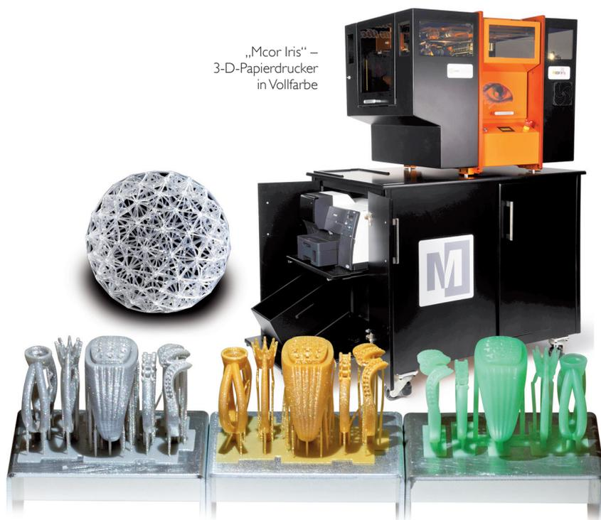
Die Stereolithografie ermöglicht die Produktion detailgetreuer Teile und Abgussmodelle
