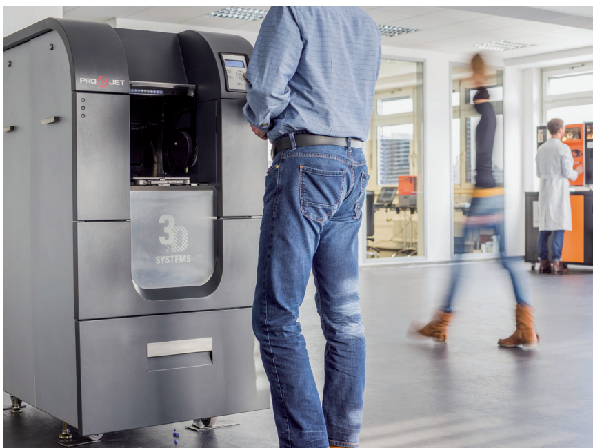
Für die kostengünstige Schmuckserienfertigung kommen die „3D Systems ProJet“-Anlagen zum Einsatz
